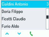
Die Tasten gestatten das Scrollen der Namen. Werden diese länger als 1 Sekunde betätigt, kann der Schnelldurchlauf erfolgen.
