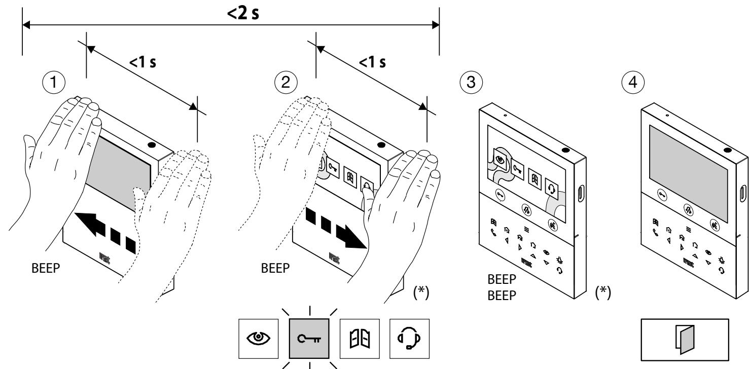
(\*) L'allumage de l'afficheur et la visualisation des icônes dans les écrans indiqués ne sont visibles que si l'appareil a été configuré en mode "**Confort**".
