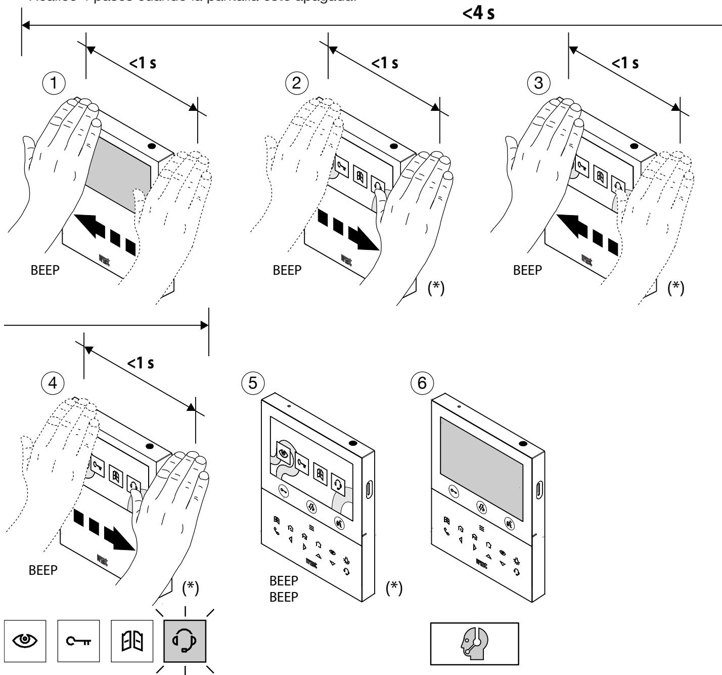
(\*) El encendido del display y la visualización de los iconos en las pantallas indicadas son visibles sólo si el dispositivo ha sido configurado en modo “Alimentación local”.
