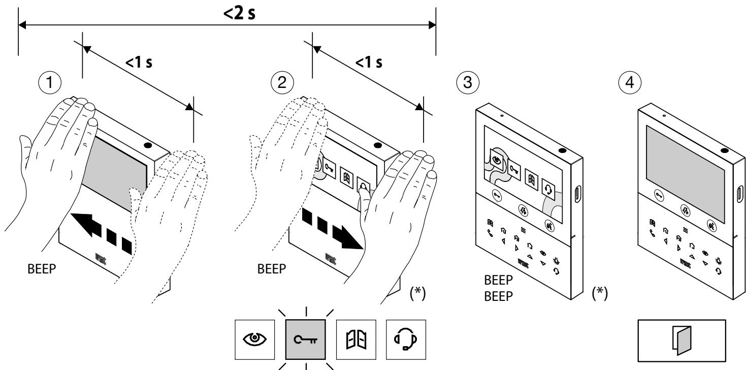
(\*) El encendido del display y la visualización de los iconos en las pantallas indicadas son visibles sólo si el dispositivo ha sido configurado en modo “**Alimentación local**”.
