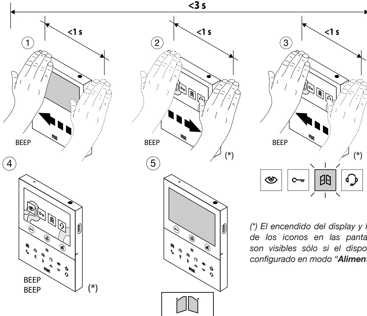
(\*) El encendido del display y la visualización de los iconos en las pantallas indicadas son visibles sólo si el dispositivo ha sido configurado en modo “Alimentación local”.
