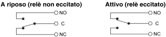
Figura 17 – Posizione dei contatti del relè
