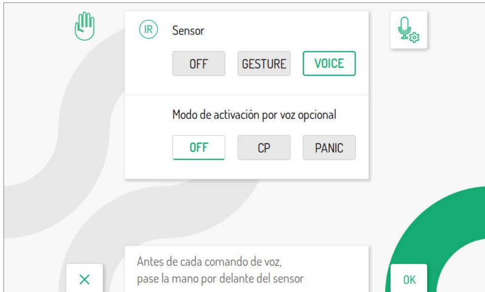
– **OFF**: activación comandos vocales pasando la mano delante del sensor IR.
