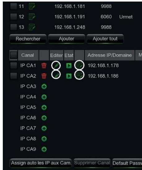
Pour modifier les données utilisées par le HVR pour connecter chaque canal, sélectionner le bouton (voir les éléments cerclés dans la figure précédente).
