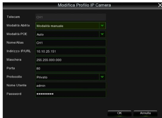
Per modificare i parametri di rete della telecamera connessa (esempio: indirizzo IP della telecamera da DHCP a statico, maschera, Gateway, porta) selezionare il pulsante
