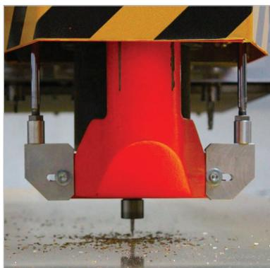
Taglio e lavorazioni meccaniche su pantografi CNC per pulsantiera Exigo, Titanium e Alumen
