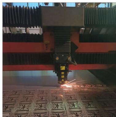
Taglio laser ad alta potenza per pulsantiera in acciaio inox della serie Allinox
