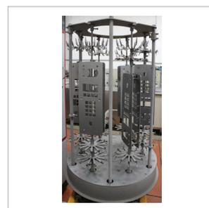
Le pulsantiere in ottone cromato o in acciaio inox vengono montate su appositi telai
